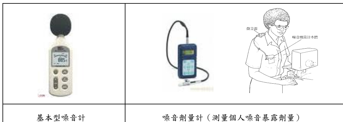
圖 8 噪音監測儀器設備
